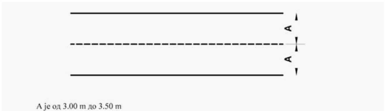
Slika 11. Prostor i oznake prostora za izvođenje poligonske radnje "odvajanje i spajanje vučnog i priključnog vozila" (za osposobljavanje kandidata za vozače vozila kategorije BE)
